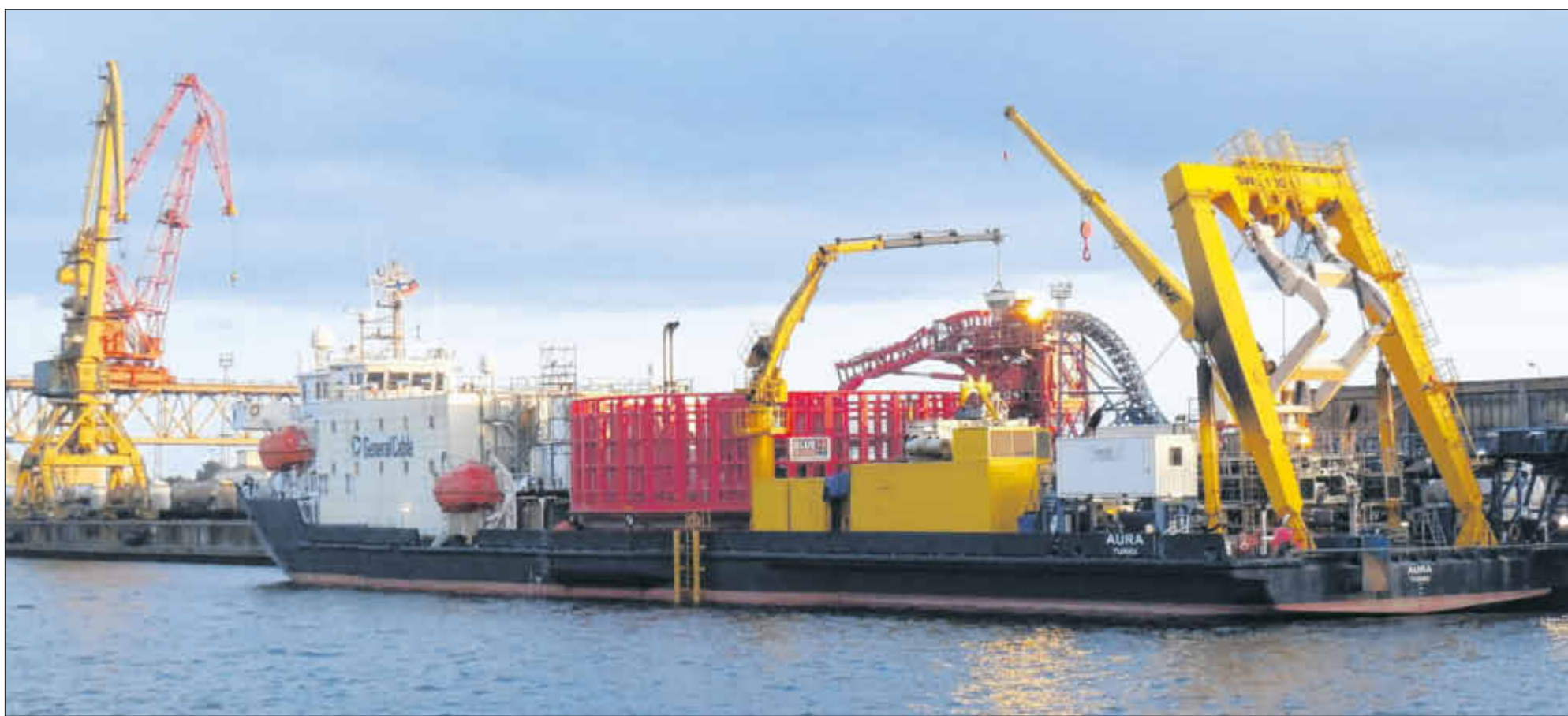
Wartet in Rostock auf Ladung: der Kabelleger „Aura“. Die Kabel werden aufgerollt (rotes Gerüst in der Mitte) transportiert und am Heck ins Wasser gelassen. Foto: Kerstin Schröder
