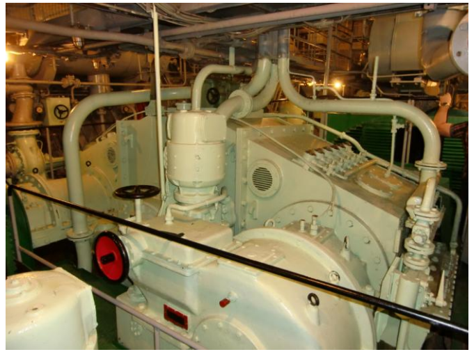
Stb-HAUPTMASCHINE & UNTERSETZUNGSGETRIEBE für 2 HM auf die Welle
